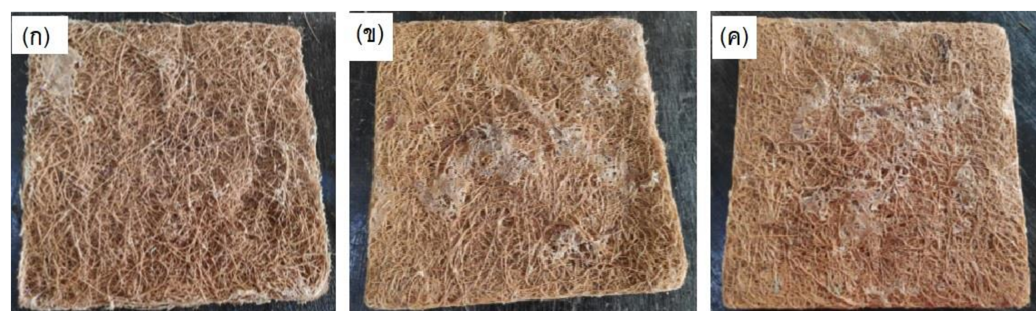
ภาพที่ 1. แสดงฉนวนกันความร้อนจากวัสดุผสมระหว่างเส้นใยมะพร้าวกับน้ำยางพารา (ก) อัตราส่วน 10:90 โดยน้ำหนัก (ข) อัตราส่วน 20:80 โดยน้ำหนัก (ค) อัตราส่วน 30:70 โดยน้ำหนัก
